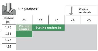
Platine soudée < Platine renforcée
